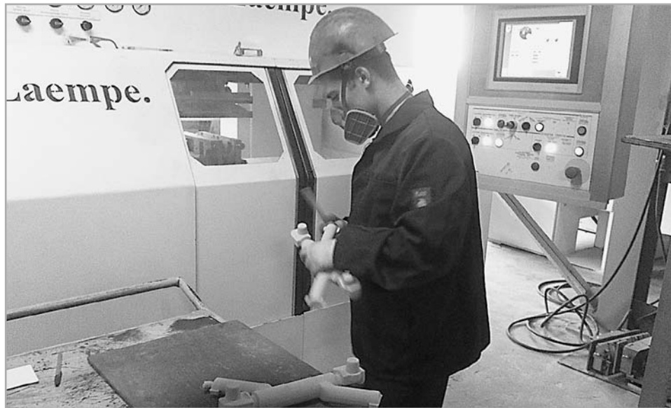
На предприятии установлено современное оборудование германского производства по изготовлению стержней
