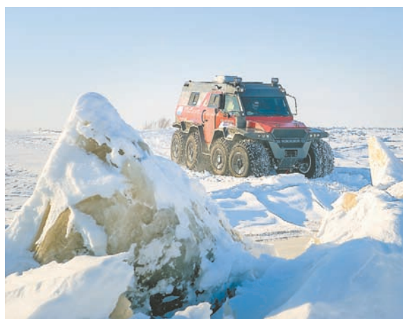
Тверской вездеход способен ездить даже боком – так называемая система «Краб»
