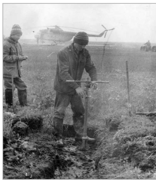
Сдвиговые испытания на вечномерзлом основании с использованием прибора BC-5 (полуостров Ямал – район Бованенского газоконденсатного месторождения)
