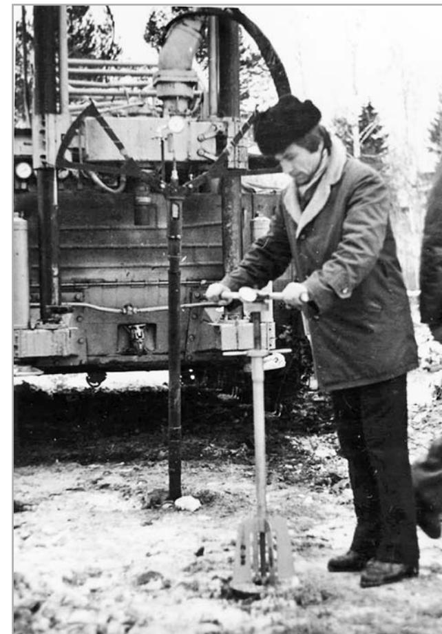
Комплексные испытания мерзлого торфяного грунта с использованием новых приборов и оборудования
