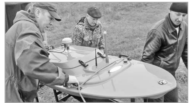
Профилограф – мечта любого мальчишки и мужчины – большая радиоуправляемая лодка и, по совместительству, прибор для измерения параметров реки
