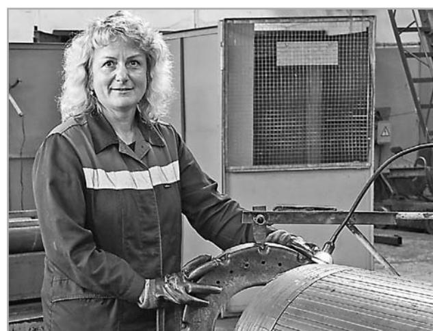
зать огромном, локомотивном депо. Нас встретила весьма энергичная и приветливая женщина. Сразу стало ясно: терять время почем зря она не привыкла. С ходу начала показывать, как происходит процесс проверки деталей на предмет дефектов. На диагностику тут же при помощи спецкрана был доставлен тот самый якорь – важнейшая многокилограммовая деталь тягового двигателя тепловоза.
