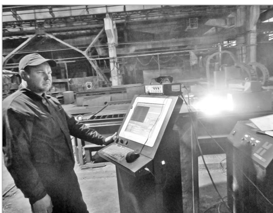
Производство оснащено самым современным оборудованием, в том числе линией газо-плазменной резки металла «Комета»
