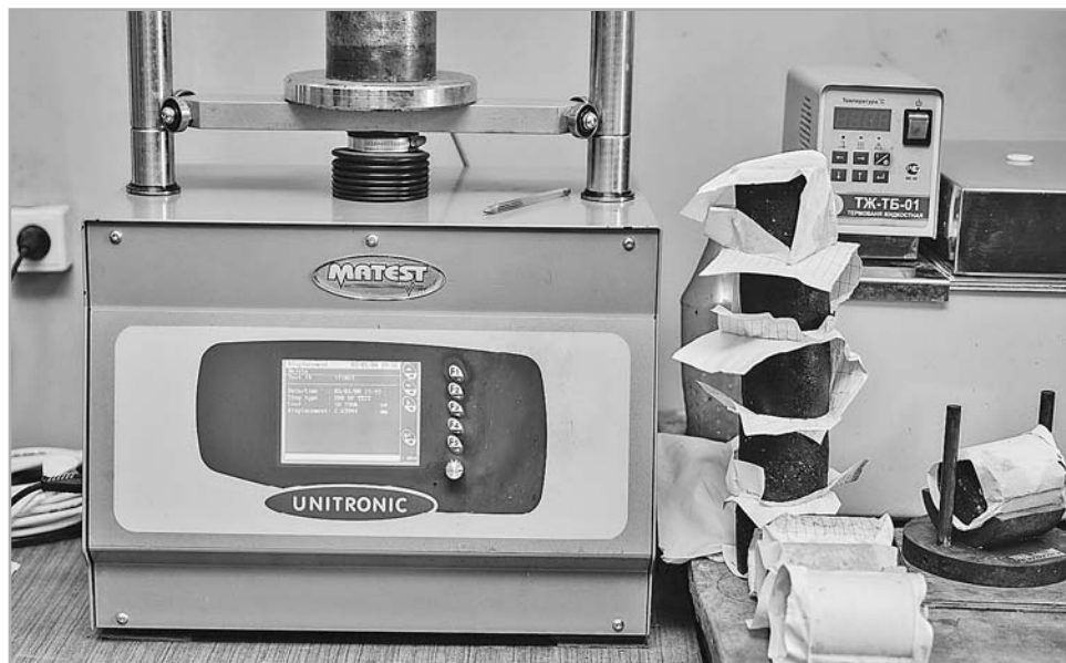
Итальянский прибор помогает проверить прочность асфальта
