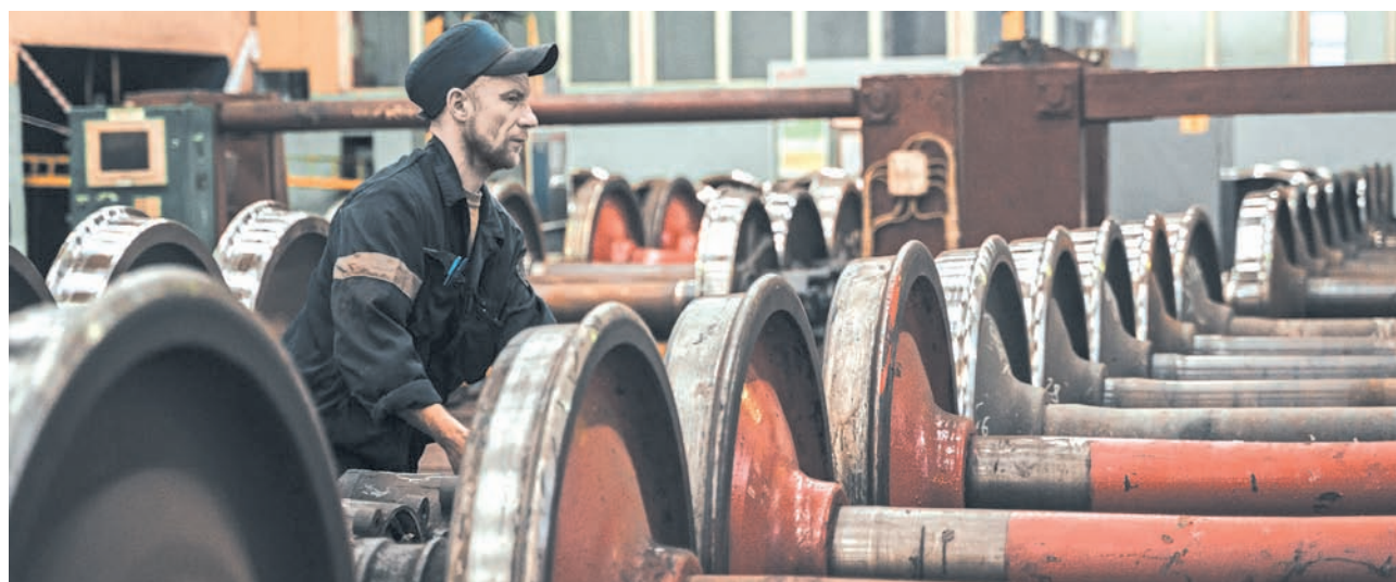
Проведение ремонта колесных пар
